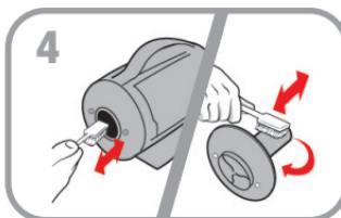
**Paso 4.** Utilice un paño suave o un cepillo y agua tibia para limpiar el impulsor y el interior de la carcasa del impulsor.
