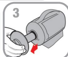
**Paso 3.** Retire el grupo del impulsor tirando suavemente de las palas del impulsor. El impulsor se mantiene en su lugar mediante un imán.
