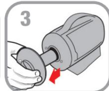
**Étape 3.** Retirez l'ensemble de la turbine en tirant doucement sur les pales de la turbine. La turbine est maintenue en place par un aimant.
