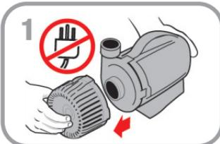
**Étape 2.** Retirez le couvercle de la turbine pour exposer l'ensemble de la turbine.
