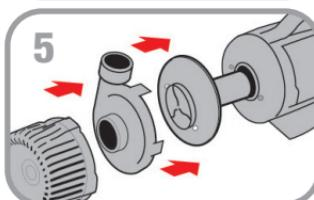
**Paso 5.** Vuelva a montar todas las partes de la bomba, coloque la pumpshield® y colóquelo en agua antes de volver a conectarlo fuente de alimentación.
