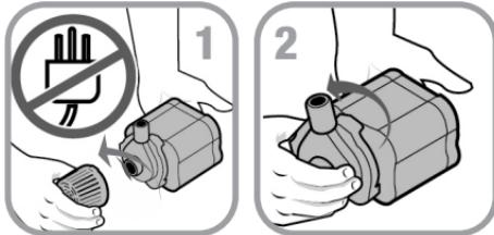
**Étape 2.** Retirez le couvercle de la turbine pour exposer l'ensemble de la turbine.
