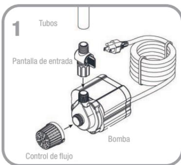
**Paso 2.** Ajuste el control del flujo al nivel más bajo. Una vez que la bomba ha sido encendida (después del paso 3) puede ajustar el control del flujo al nivel preferido.
