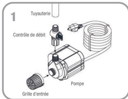
**Étape 2.** Ajustez le contrôle de débit au réglage le plus bas. Une fois que la pompe a été allumée (après l'étape 3), vous pouvez ajuster le contrôle de débit au réglage préféré.
