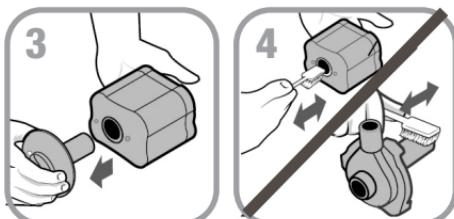
**Étape 3.** Retirez l'ensemble de la turbine en tirant doucement sur les pales de la turbine. La turbine est maintenue en place par un aimant.
