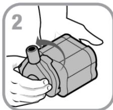
**Paso 2.** Retire la cubierta del impulsor para exponer el grupo del impulsor.
